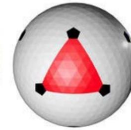
Section de géode : surface composée de triangles équilatéraux, entre 3 des 12 "sommets" pentagonaux
